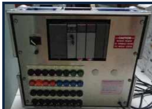
Allen Bradley SLC 5/03
