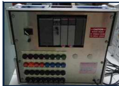
Allen Bradley SLC 5/03
