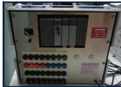
Allen Bradley SLC 5/03
