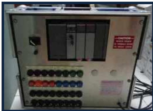
Allen Bradley SLC 5/03
