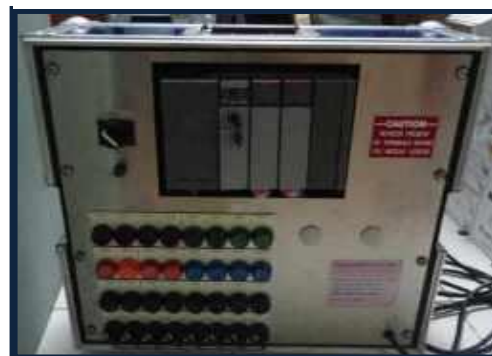
Allen Bradley SLC 5/03
