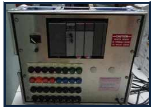
Allen Bradley SLC 5/03
