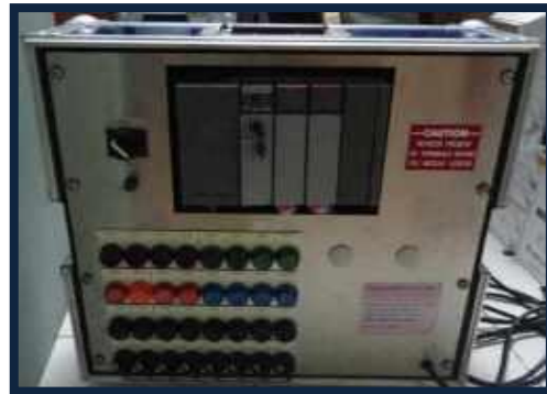
Allen Bradley SLC 5/03
