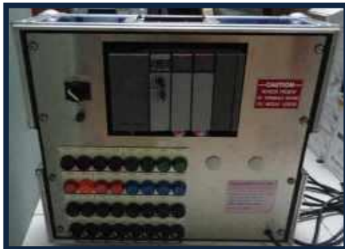
Allen Bradley SLC 5/03
